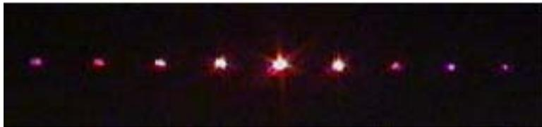
**Figure 10** : Figure de diffraction d'un réseau linéaire.
