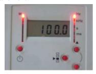
Les calibres sont automatiques, et la mesure passera de « **Hz** » à « **kHz** » et vice-versa, sans qu'une action de l'opérateur soit nécessaire.
