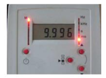
Les calibres sont automatiques, comme pour les fréquences, et la mesure passera de « s » à « ms » et vice-versa, sans qu'une action de l'opérateur soit nécessaire.
