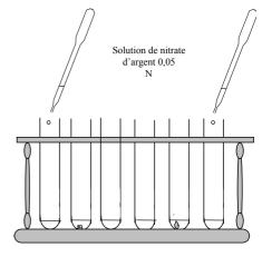
On fait le test au nitrate d'argent, on obtient un précipité blanc (présence d'ions chlorure).
