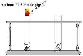
On retire le bouchon et aussitôt on plonge la flamme d'une allumette dans le tube à essai contenant le zinc : un aboiement se fait entendre : du dihydrogène s'est formé.
