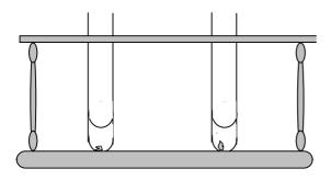
Mesure du pH avec un papier indicateur de pH. On mesure le pH des solutions dans chaque tube : il a augmenté : de l'acide chlorhydrique a disparu.
