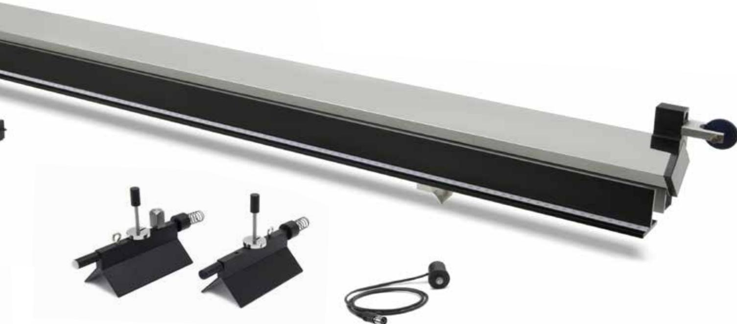
Référence 34010 : Cet ensemble est composé du banc à coussin d'air, de 2 chariots et accessoires et de 2 accessoires de fixation pour cellules photoélectriques.
