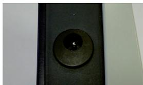
Connectez la fiche de l'adaptateur secteur au connecteur situé sur la tranche gauche de l'appareil en utilisant le jack indiqué ci dessous et en respectant la polarité
