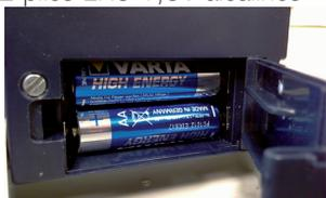
Insérez les 2 piles dans la trappe à piles à l'arrière du boîtier.
