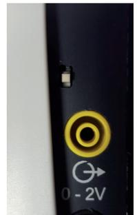
Lorsque l'appareil est stocké, pour éviter une décharge des piles, placez le petit interrupteur vers le bas.
