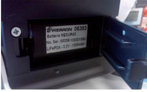
Insérez les batteries rechargeables spéciales Mesura<sup>2</sup> dans la trappe à piles à l'arrière du boîtier.
