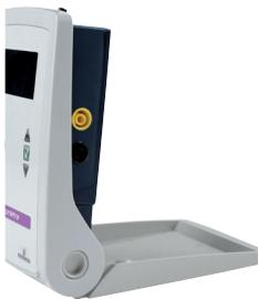
Un signal analogique compris entre 0 et 2 V et proportionnel à la valeur mesurée est disponible sur les douilles de sécurité  $\varnothing$  4 mm de la sortie analogique située sur la tranche droite de l'appareil.
