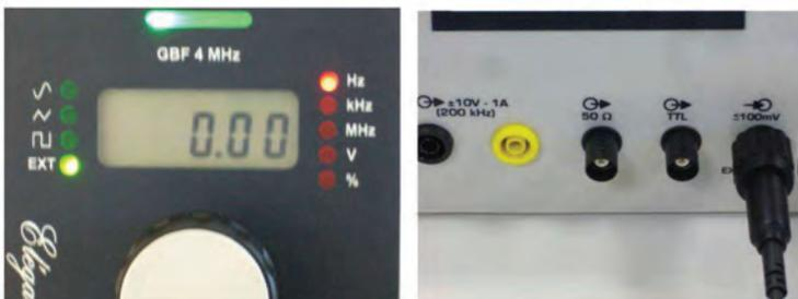
Cette configuration permet de transformer l'appareil en un fréquencemètre, et ainsi de mesurer la fréquence d'un signal extérieur connecté à l'entrée « EXT  $\pm \leq 10$  V » (15).
