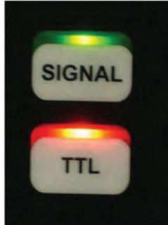
Le bouton « TTL » s'allume lorsqu'on appuie dessus. Ce mode transforme le signal de sortie, quelque soit la forme choisie. La tension du signal passe automatiquement à 5 V, et devient positif (position DC de l'entrée de l'oscilloscope).
