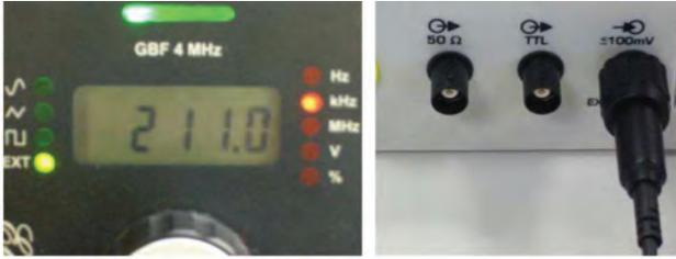
A - Permet de transformer l'appareil en un fréquencemètre, et ainsi mesurer la fréquence d'un signal extérieur connecté à l'entrée « EXT  $\leq \pm 10$  V » (15).
