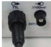
**Particularité** : contrairement à la sortie TTL, le signal sortant de la sortie 50  $\Omega$ , en position « TTL », est également influençable par les actions sur les boutons « OFFSET », « LEVEL (avec l'offset) », « -20 dB ».
