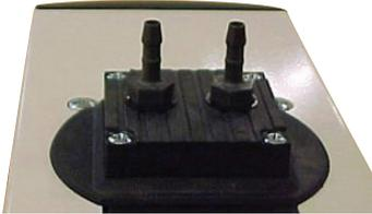
Ôter l'obturateur de protection d'embout de la « tétine » de refoulement de l'air (signe > gravé devant l'embout).
