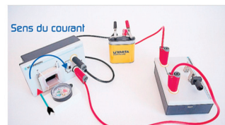
La face avant de la bobine est un pôle SUD , conformément à la règle du tire-bouchon de Maxwell.
