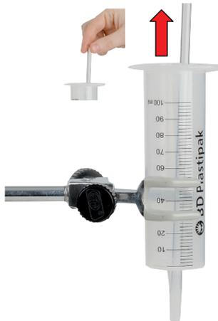
Libérer le volume d'eau. On réalise ce « lâcher » en tirant sur l'obturateur, rapidement (voir mode d'emploi plus loin). L'eau tombe sur la pale (à cet instant et afin que plus aucune goutte ne tombe sur le moulinet, interposer une main). La roue tourne tout en se déplaçant horizontalement de  $d_1$  mm. On note cette valeur.
